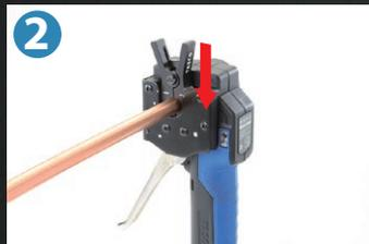
2 銅管を挟んだ状態のクランプを本体にセットします。クランプの線と本体の▲マークを合わせるのが目安となります。
