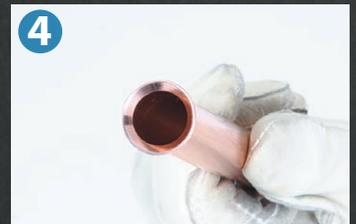
4 銀色のレバーを戻し、本体からクランプを外し、クランプから銅管を外します。綺麗で一定のフレア加工が完了です。
