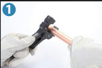
1 適合するサイズのクランプに銅管を挟み込みます。面出しプレートに当たる位置で挟み込むのがポイントです。
