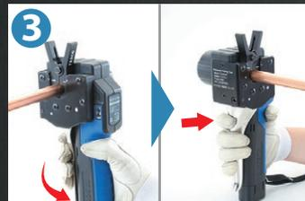
3 銀色のレバーを引きクランプを固定します。その後、本体のボタンを押すと自動的にコーンが前進・後退して停止します。
